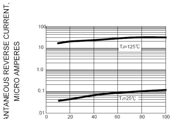
**FIG.4 – TYPICAL REVERSE CHARACTERISTIC**
