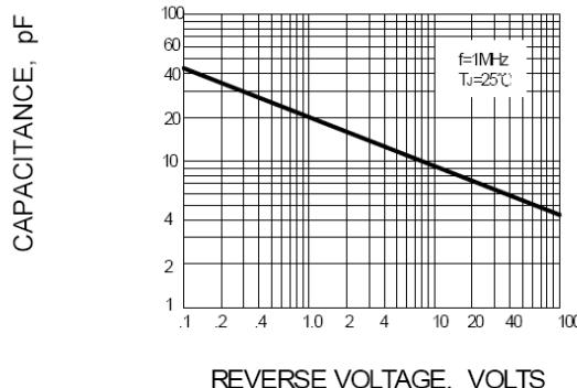
**FIG.5 – TYPICAL JUNCTION CAPACITANCE PER ELEMENT**
